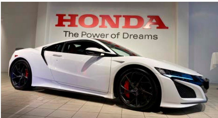
Vélin í Honda NSX er V6 bensínvél en með hjálp rafmótora skilar bíllinn tæpum 600 hestöflum.
