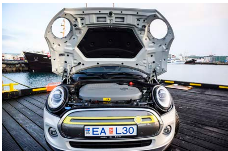
Rafmótorinn er festur með sömu festingum og bensínvélín sem auðveldar framleiðsluferlið.
