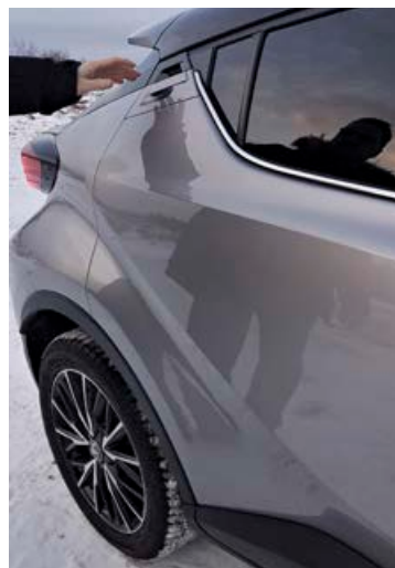
Handfang fyrir afturhurð er eins ofarlega og hægt er sem er ekki gott.
