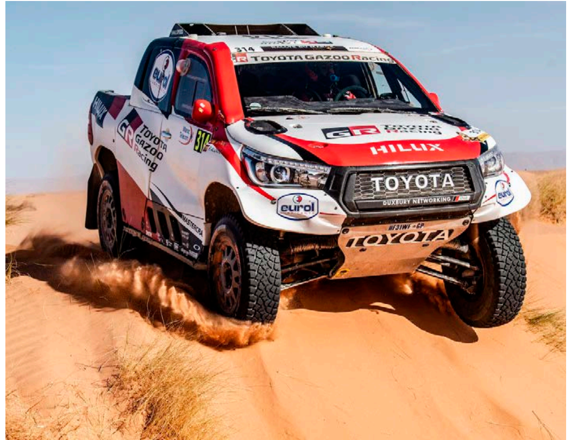
Toyota Hilux keppnisbíllinn er sérsmíðað tryllitæki með tæplega 400 hestafla V8-vél aftur í bilnum.
