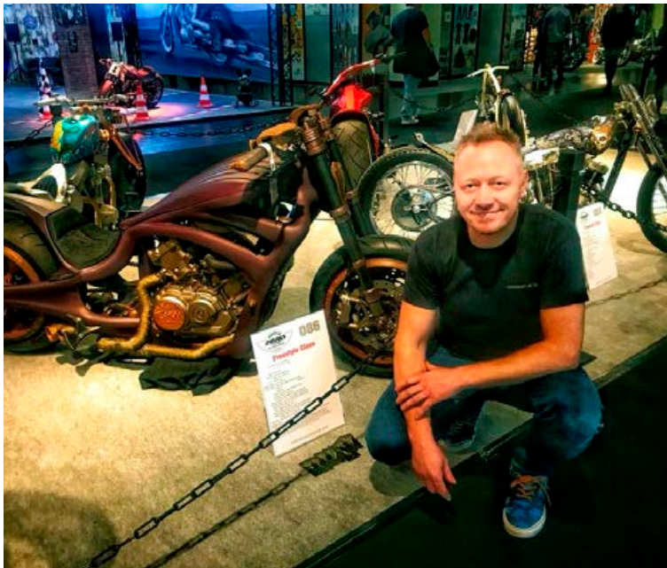
Ólafur stillir sér upp á mótorhjólasyningunni í Köln við hliðina á hjóli sem hann hannaði og smíðaði sjálfur, með grind úr koltrefjum og felgur úr tré.
