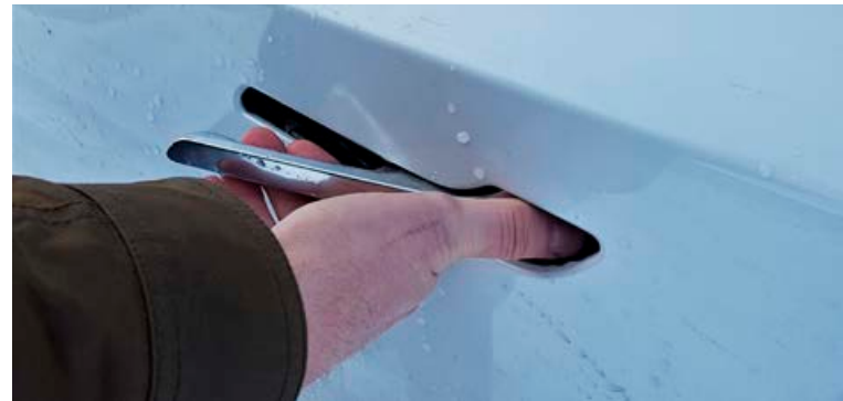
Hurðarhandföng eru innfelld líkt og í Tesla Model S en ekki rafdrifin. Lenti greinarhöfundur einu sinni í því að þau frusu föst í átta gráðu gaddi.
