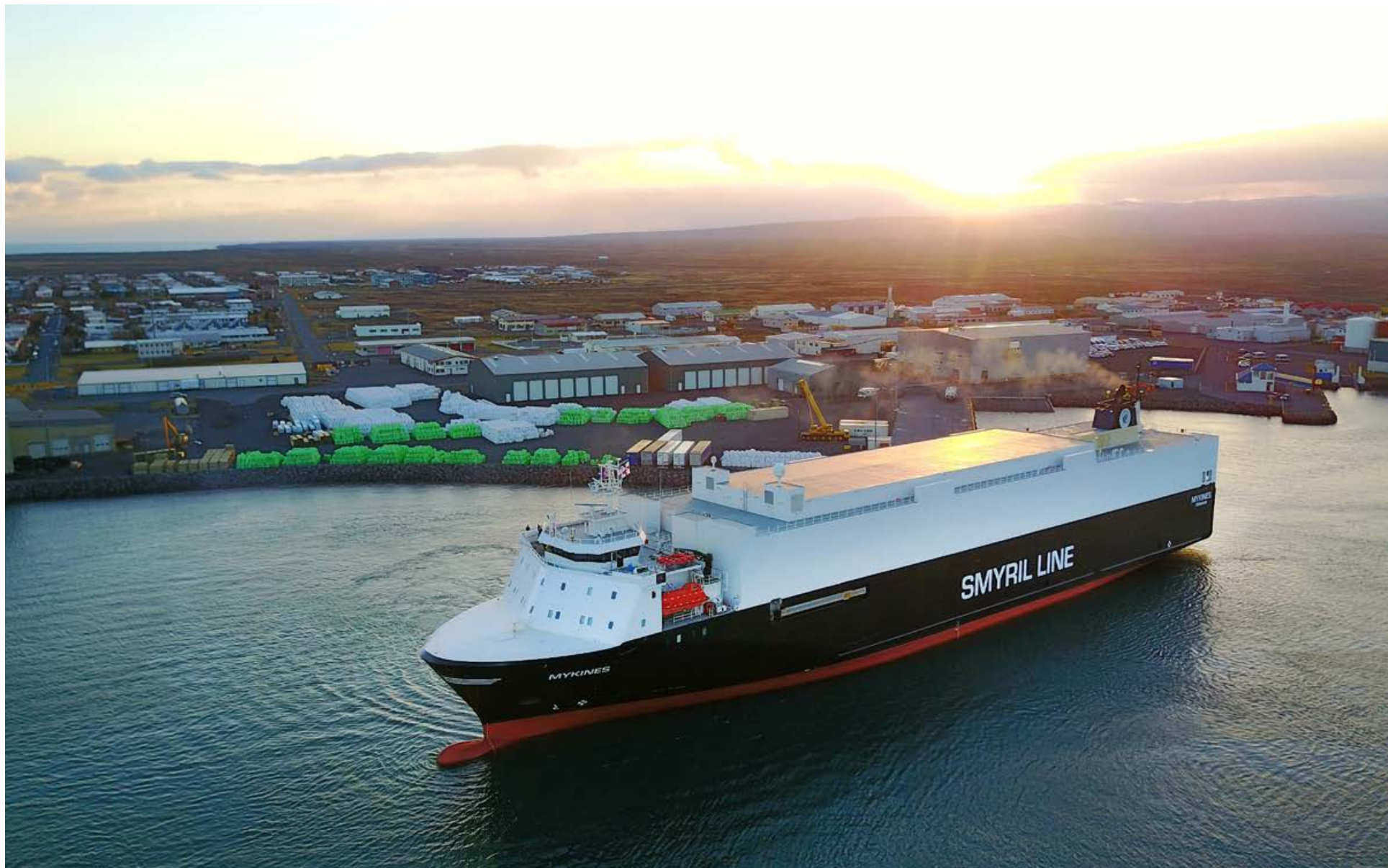
Mykines er fraktflutningaskip sem siglir milli Þorlákshafnar og Rotterdam með viðkomu í Þórshöfn. Ferjan er svokölluð Ro/Ro ferja sem þýðir að allur vöruflutningur fer fram á hjólum um borð.
