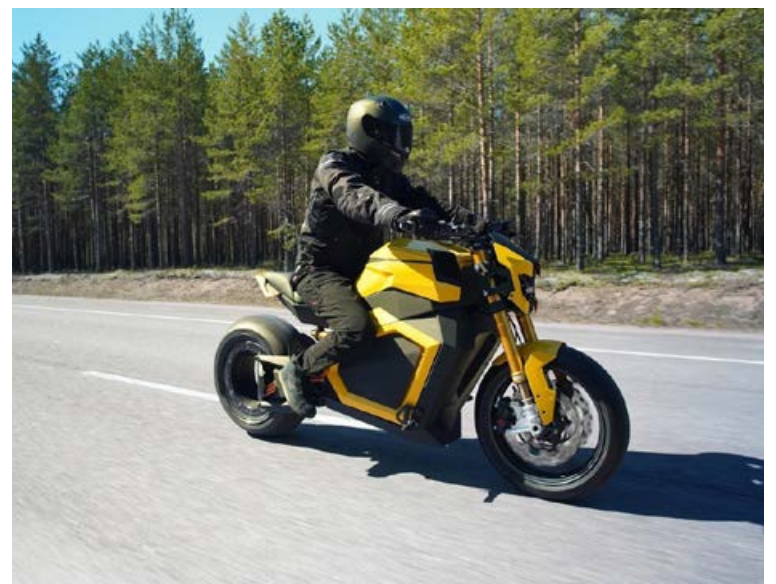
Verge-rafhjól er með afturhjul án miðju og er mótorinn hluti af felgunni.
