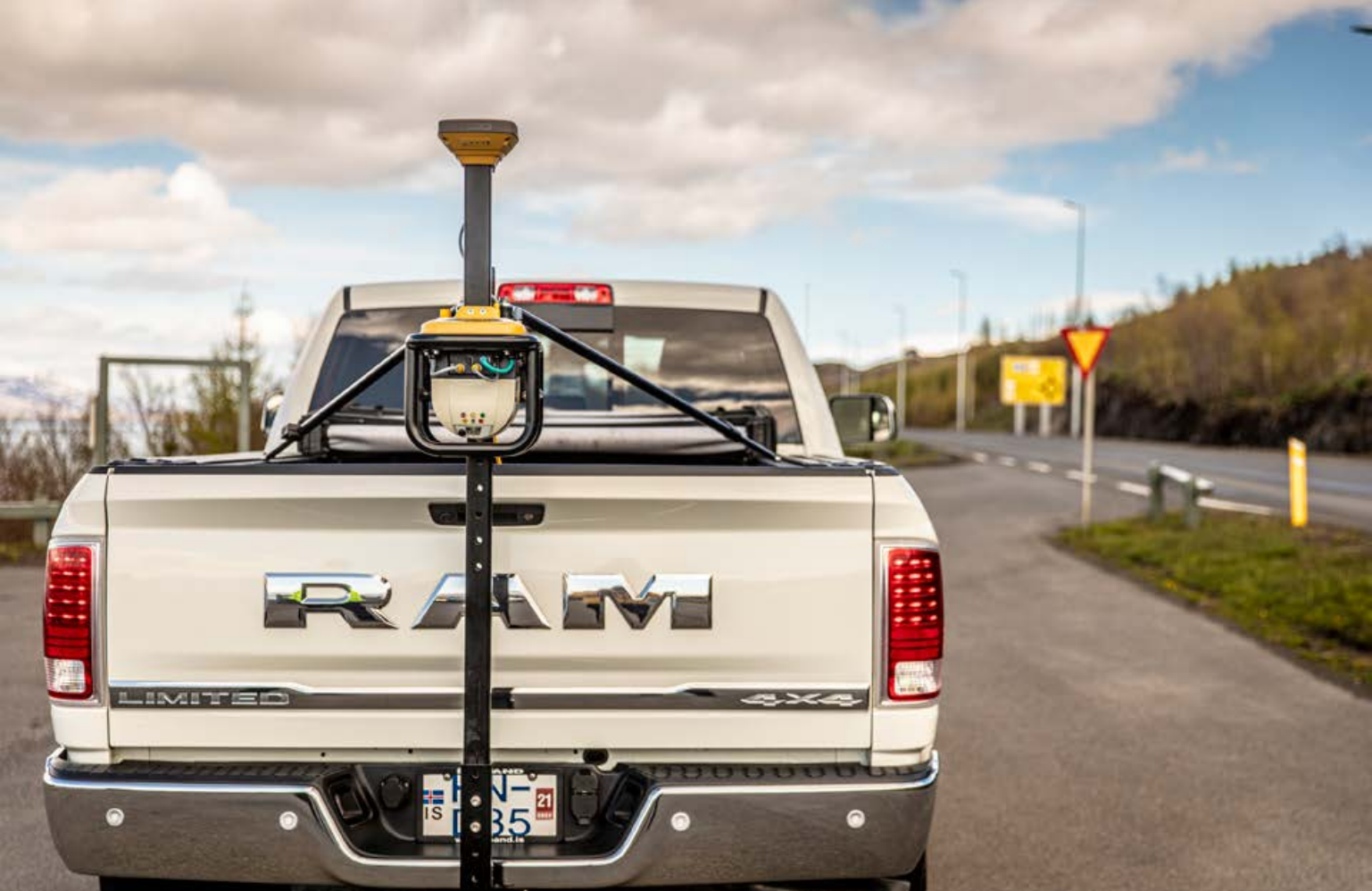
Með nýrri vegskönnunartækni frá Topcon er auðvelt að skanna ástand gatna áður en malbikunarframkvæmdir hefjast. FRÉTTABLAÐIÐ/AUÐUNN NIELSSON
