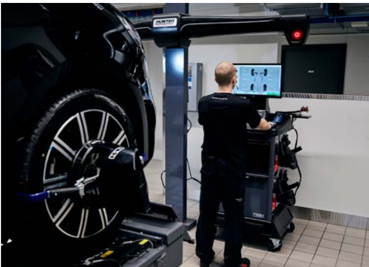
Það eru ýmsar nýjungar á verkstæðunum núna, það má meðal annars nefna þrívíddar hjólastillingar- búnað og hemla- og fjöðrunarpróf.
