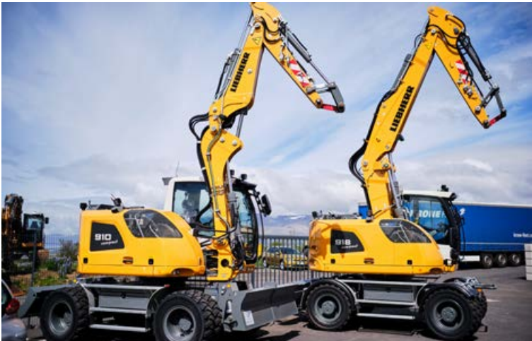
Liebherr A910 Compact 12,5 tonn og A918 Compact 17,5 tonn.
