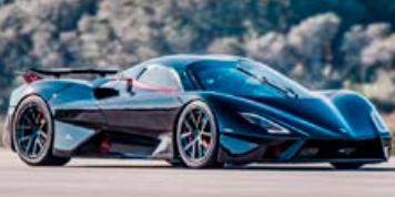
SSC Tuatara er með 5,9 lítra V8 vél sem skilar 1.750 hestöflum og 1.735 newtonmetra togi og fer allt aflið til afturhjólanna eingöngu.
