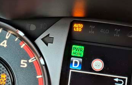
Sjálfvirk tregðulæsing eða Auto LSD virkar aðeins þegar bíllinn er í afturhjóladrifi undir 50 km á klst.
