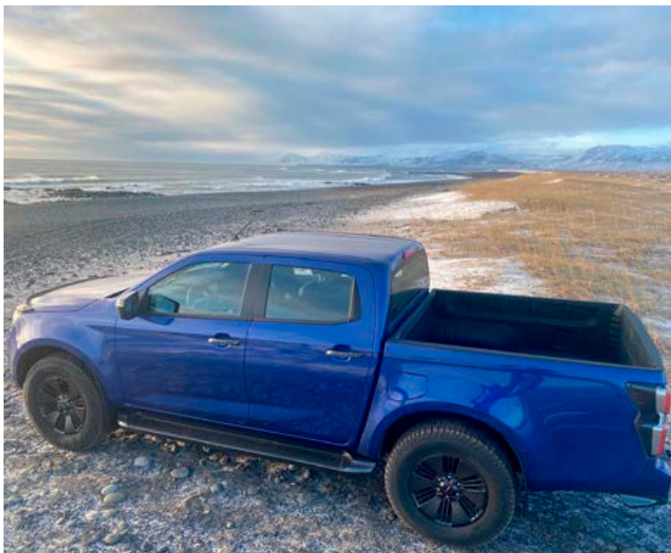
Pallurinn ber 1.065 kg og er 1.530 sinnum 1.570 mm, og dýptin 490 mm.
