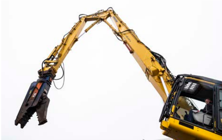
Kjafturinn á arminum á Komatsu niðurrifsvélinni er sérstaklega hannaður til þess að brjóta niður allt að eins metra þykka steinsteypu.
