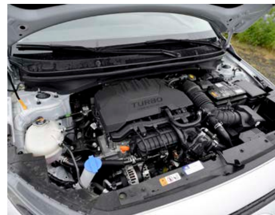
Vélin er þriggja strokka og skilar 100 hestöflum sem er í minna lagi og ekki hægt að biðja um meira.
