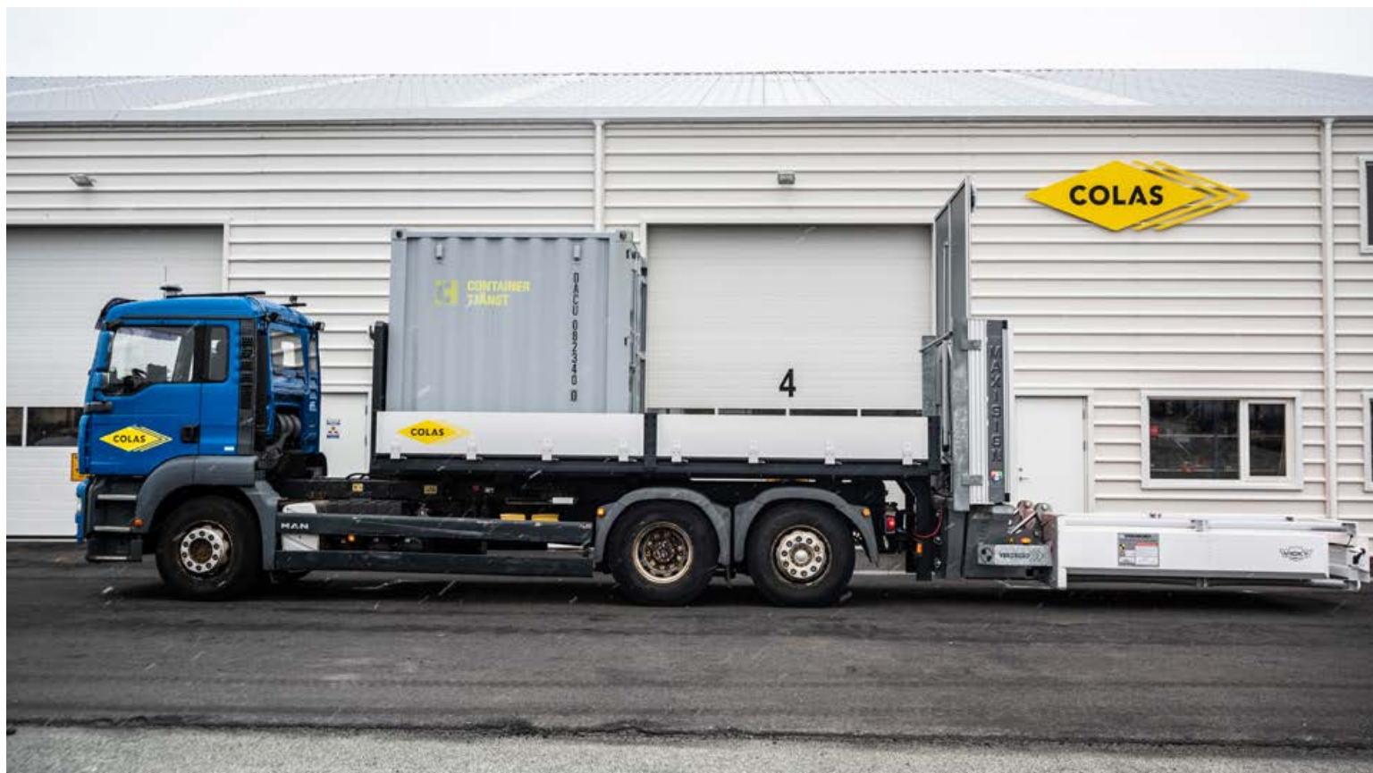
Colas á tvo þúðabíla, einn sem er festur er á vörubíl og notaður við götur þar sem umferð er mikil og hröð og annan minni þar sem umferðarhraði er minni.
