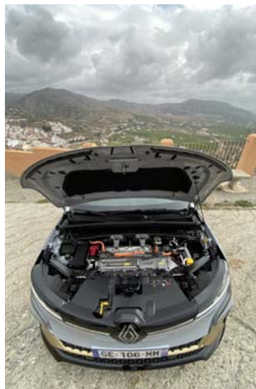
Búið er að koma rafmótor og miðstöðvarkerfi haganlega fyrir frammi.
