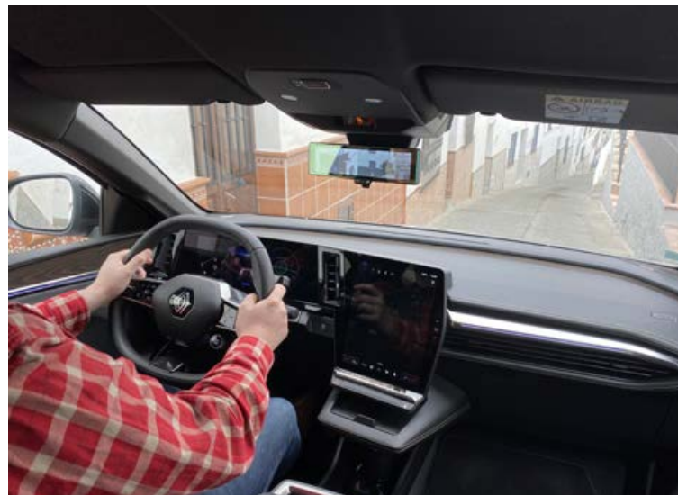
Mælaborðið er hannað utan um ökumann með stórum, lóðréttum upplýsingaskjá í miðjustokki og þægilegum upplýsingaskjá fyrir framan ökumann.
