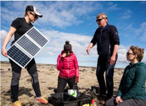
Breiðbandsmælirinn getur sýnt hátíðnihreyfingar upp í 250 ríð og hægari hreyfingar með bylgjum allt niður í 20 sekúndna bylgjulengd.
