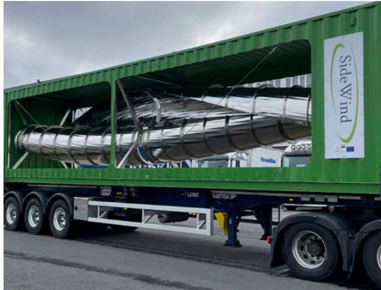
Vindmylla er sett lárétt inn í gám og tengd við rafal sem er staðsettur þar.
