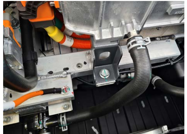
Hér má sjá áður nefndan frágang á festingum fyrir búnað fyrir rafmótorninn.
