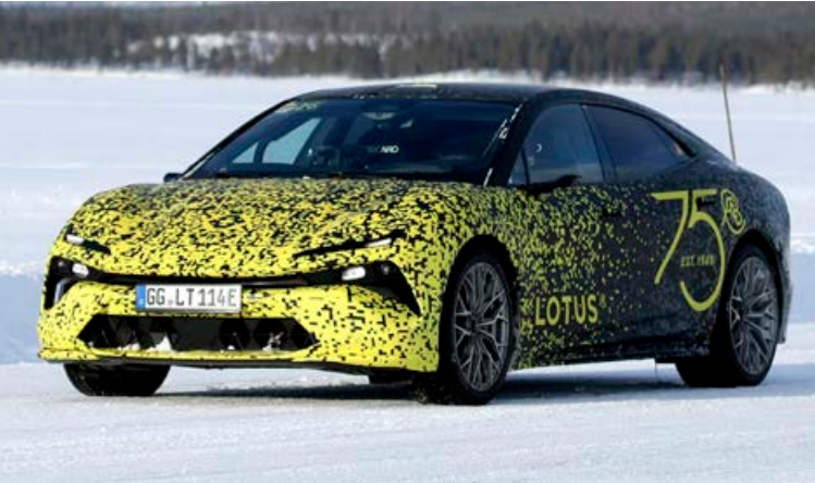
Að framan eru opnanleg loftinntök auk kælihraufa fyrir frambremsur bílsins. MYND/AUTO EXPRESS
