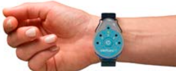
Armbandið gengur fyrir rafhlöðum og gefur frá sér milda rafpúlsa sem örva miðtaugina í úlnliðnum.
