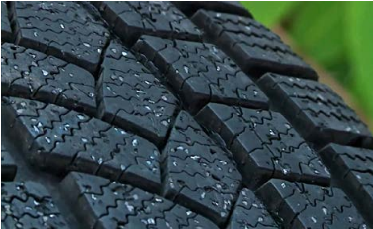
Iðnaðardemanturinn í Green Diamond dekkinu er vel sjáanlegur og nær hann gegnum allt slitlag dekkisins. Virknin varir því allan líftíma dekkisins.
