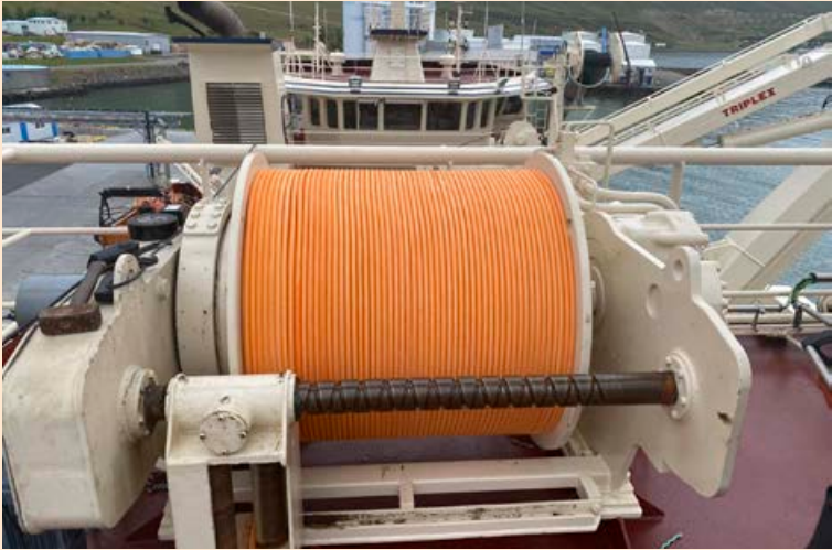
Ljósleiðari Hampiðjunnar er settur á spil sem nær niður í troll. MYND/ADSEND
