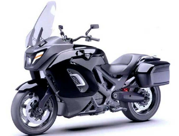
Svo virðist sem að Aurus-mótörhjólíð sé raðdrifið enda enginn skiptipedali á vinstri hlið eins og sjá má á myndinni sem birtist af hjólinu nýlega.
