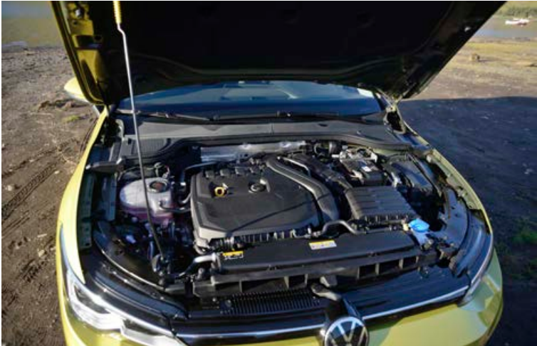
Það er lítið pláss eftir í vélarrýminu á bílnum með 1,5 litra eTSI vélinni.
