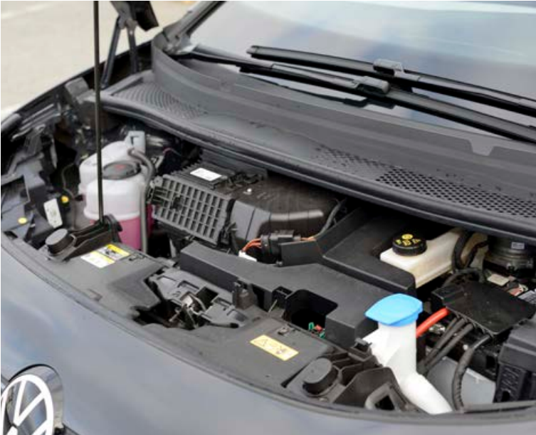
Bíllinn er frekar snubbóttur að framan enda engin þörf á öðrum búnaði þar en áfyllingu fyrir rúðu- og hemlavökva ásamt loftkælingu.
