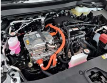
Rafmótórin er 204 hestöfl og sér um að skila aflinu til framhjólanna.
