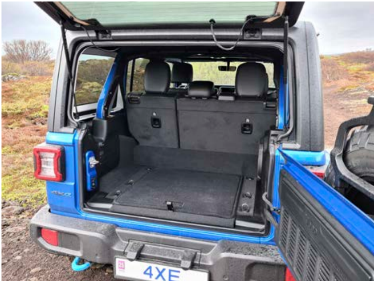
Þar sem rafhlöðu er vel fyrir komið undir aftursæti tekur hún ekki mikið pláss frá farangursrými, en þar má setja fyrirferðarmikla hluti.
