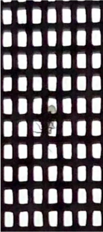
Mikið stækkuð mynd af lús-mýsneti sýnir að flugan kemst ekki í gegn.
