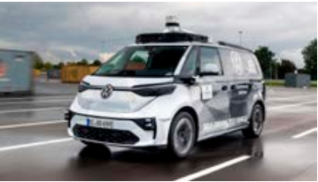
Meðal búnaðar sjálfkeyrandi ID.Buzz eru 11 radarskynjarar og 14 myndavélar ásamt sex hliðarskynjum.
