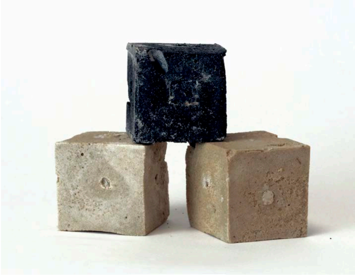
Flísarnar verða gerðar úr blöndu af bakteríum sem vaxa og mynda kristal og sand.
