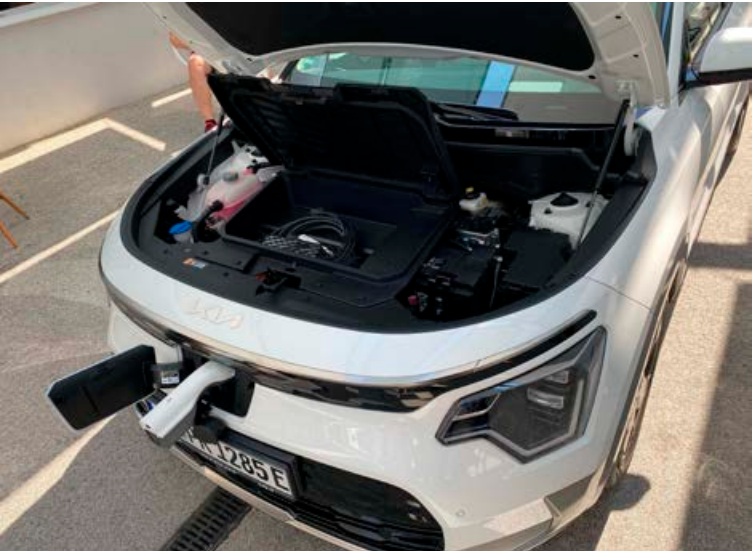
Undir húddinu er 20 lítra farangursrými og hleðslutengi er nú fyrir miðju sem breyta má í innstungu með einföldum búnaði.
