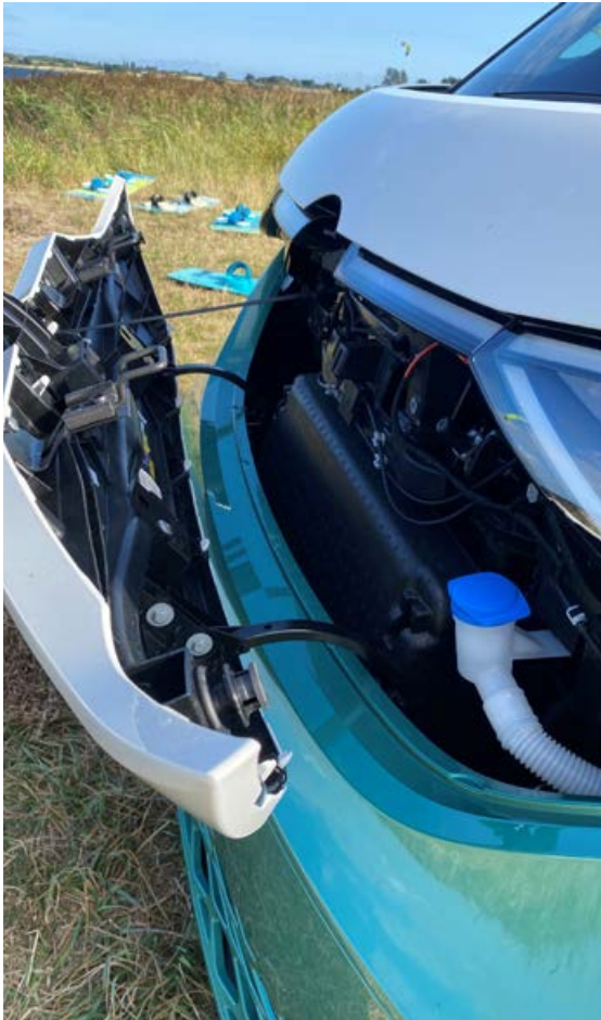
Ekki er hægt að tala um vélarhlíf en undir plastlokinu má komast í hluti eins og áfyllingu fyrir rúðupissið.
