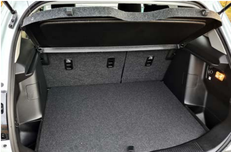
Þar sem tvinnbúnaðurinn er undir farangursrými er ekkert aukapláss þar.
